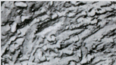
劣质斗齿的微观结构
